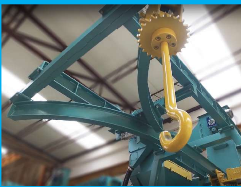
Askı Sistemi / Hanger System
